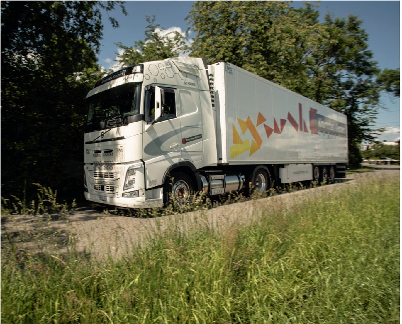
Während LKW mit komprimiertem Erdgas (CNG) Reichweiten von 200 bis 300 Kilometern haben, sind es beim LNG-Lkw (Bild) aus Volvo-Produktion, den Krummen Kerzers einsetzt, bis zu 1000 Kilometern. Hierbei ist allerdings zu berücksichtigen, dass das LNG-Fahrzeug nicht nur mit einem LNG-Tank (205 Kilogramm), sondern zusätzlich mit einem Diesel-Tank (170 Liter) ausgerüstet ist, der einen Teil der grösseren Reichweite sicherstellt.
