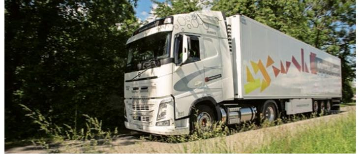
Während LKW mit komprimiertem Erdgas (CNG) Reichweiten von 200 bis 300 km haben, sind es beim LNG-LKW (Bild), wie ihn Krummen Kerzers von Volvo einsetzt, bis zu 1000 km. Hierbei ist allerdings zu berücksichtigen, dass das LNG-Fahrzeug nicht nur mit einem LNG-Tank (205 kg), sondern zusätzlich mit einem Dieseltank (170 l) ausgerüstet ist, der einen Teil der grösseren Reichweite sicherstellt. Fotos: Krummen Kerzers
