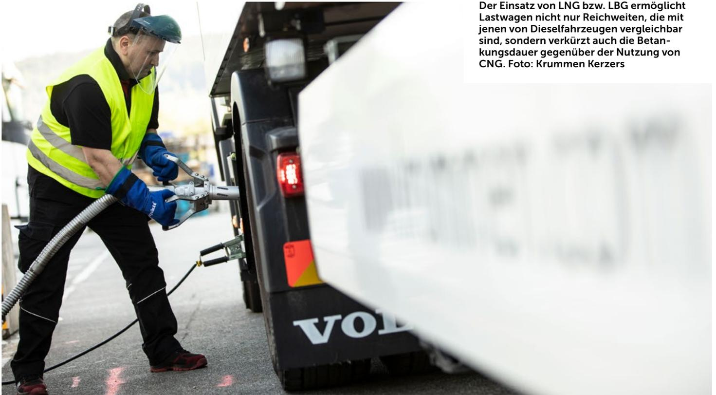
Der Einsatz von LNG bzw. LBG ermöglicht Lastwagen nicht nur Reichweiten, die mit jenen von Dieselfahrzeugen vergleichbar sind, sondern verkürzt auch die Betankungsdauer gegenüber der Nutzung von CNG. Foto: Krummen Kerzers
