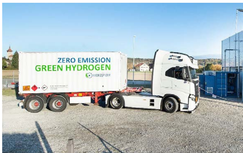
Container, die von der Hydrospider AG verwendet werden, um Wasserstoff von der Produktion zu den Tankstellen zu transportieren. © Hydrospider/Jean-Luc Grossmann
