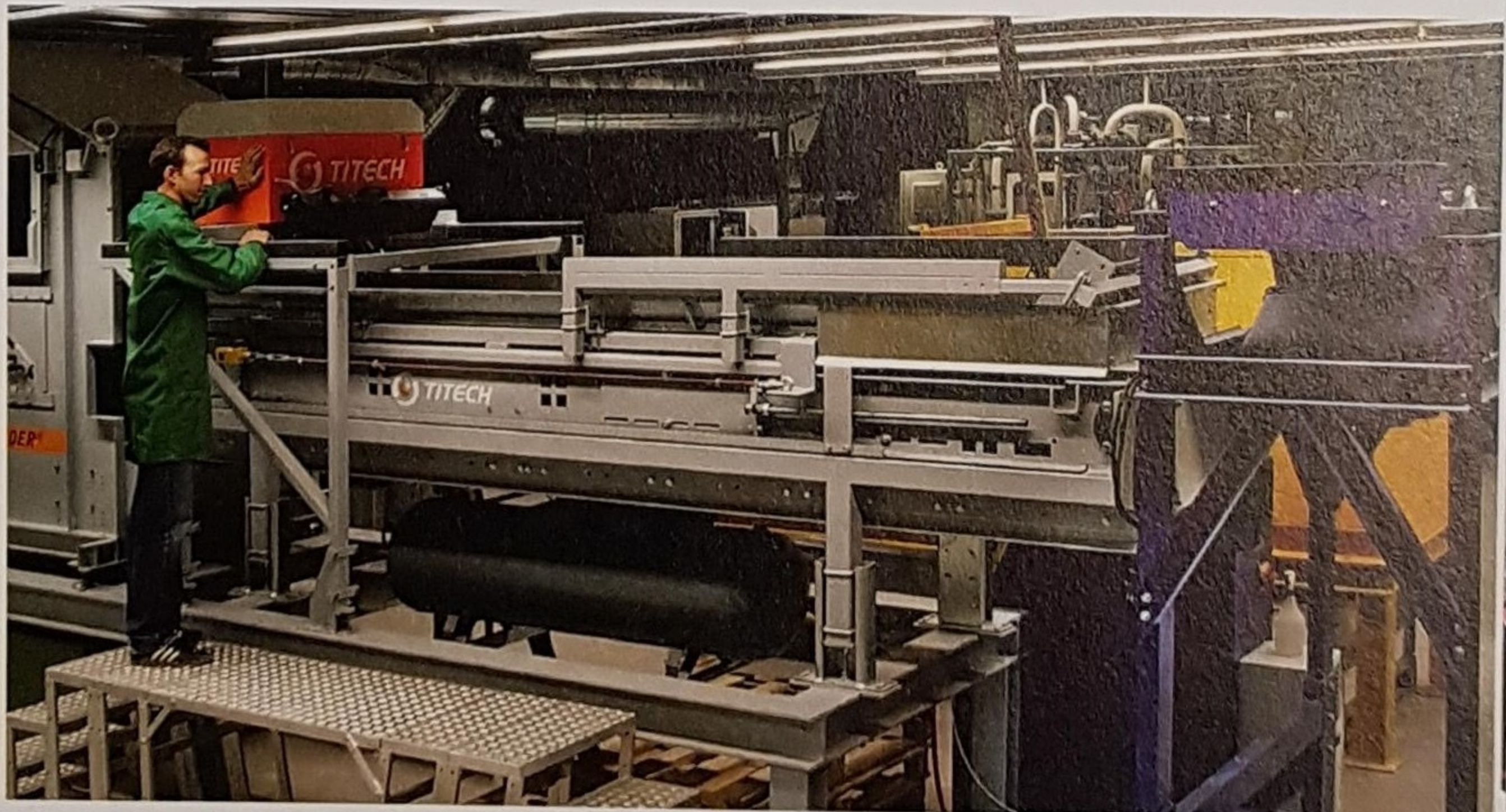
Sensorsortierer: Recycling von Kunststoffen und Metallen.
