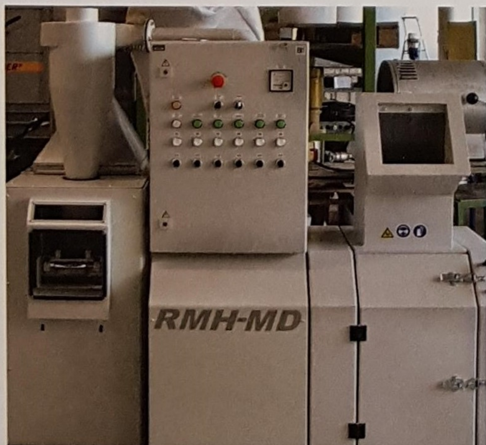
Kabelgranulieranlage: Recycling von Kupfer aus Kabelschrott.
