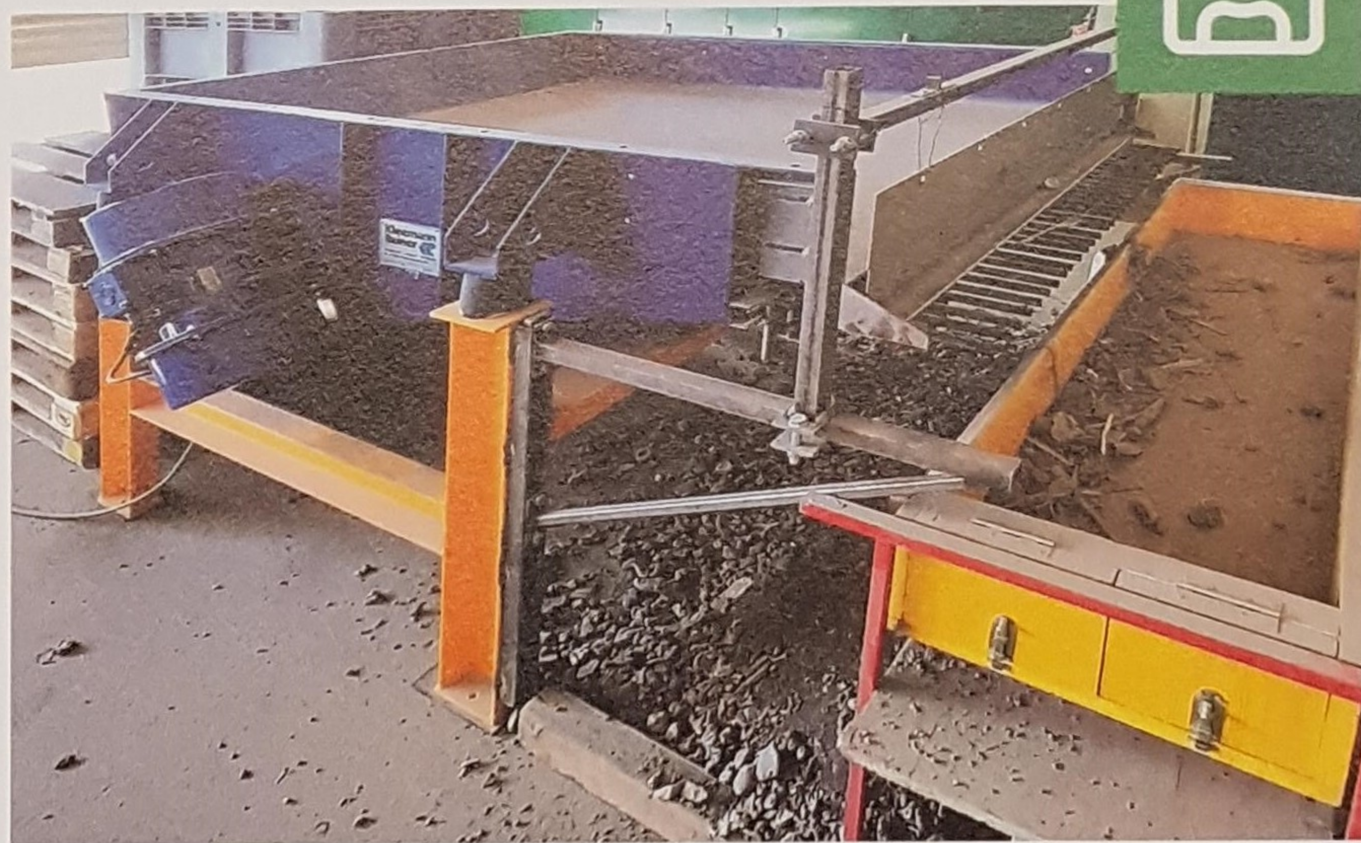
Langteilseparator: Separation von Besteck und anderen Edelstahlteilen aus Kehrrichtverbrennungsasche.
