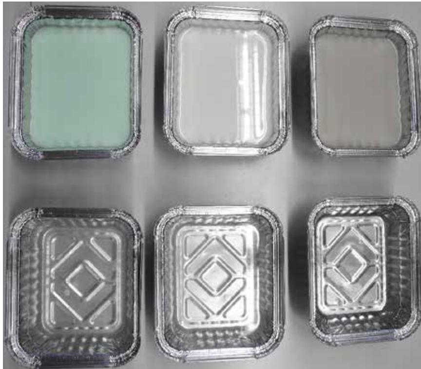
**Abbildung 20:** Proben zur TR-Bestimmung. Obere drei Schälchen enthalten Rohabwasser in den unteren drei ist der jeweilige Ablauf aus den Flockungsanlagen nach der Filtration enthalten.
