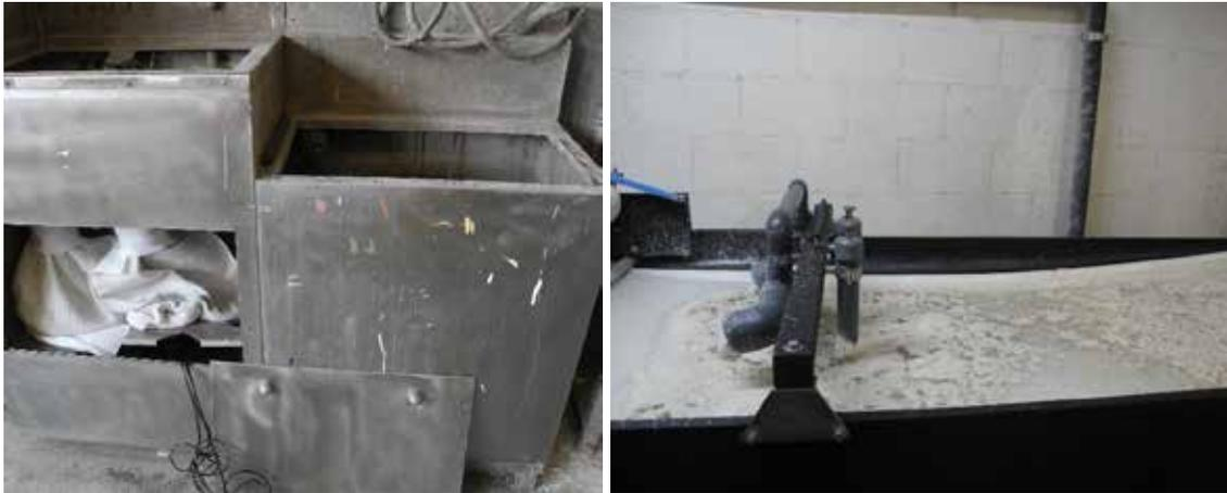
**Abbildung 19:** linkes Bild: Flockungsstation mit 50 Liter Chargenvolumen und Filtersäcken; rechtes Bild: Bandfilter nach einer Flockungseinheit
