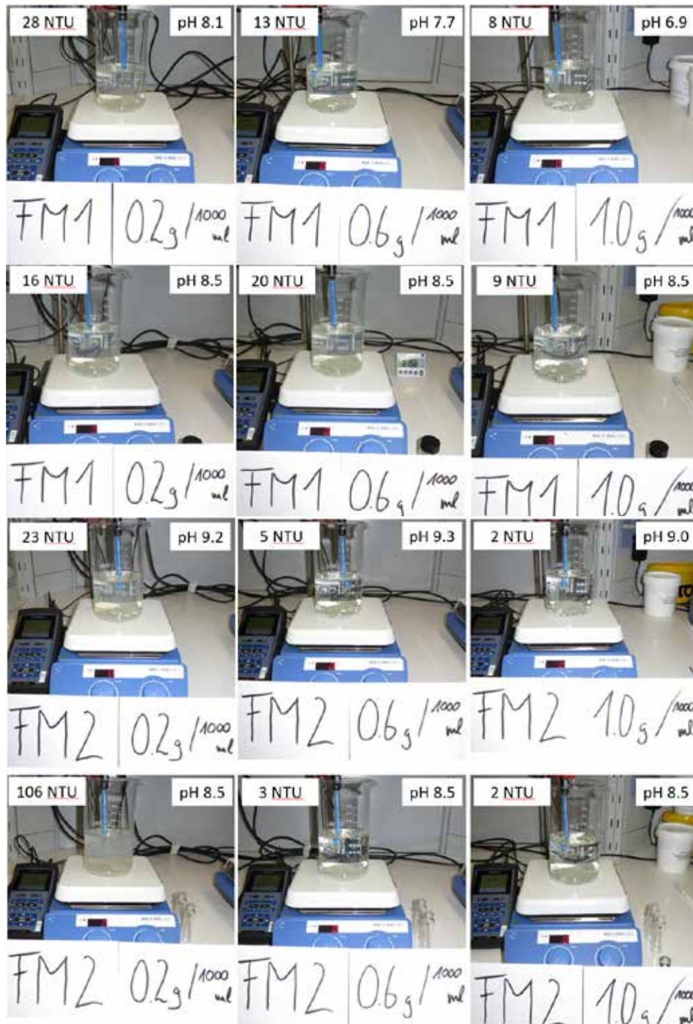
**Abbildung 21:** Flockungsmitteltest: Bilder der sedimentierten Flockungsversuche mit dem FM1 und FM2 bei unterschiedlichen Flockungsmitteldosierungen (0.2 g/l, 0.6 g/l und 1.0 g/l) und unterschiedlichen pH Werten (pH frei und pH 8.5).
