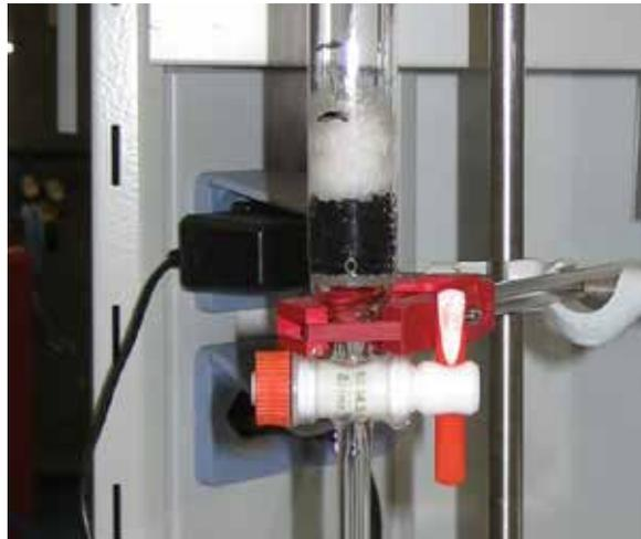
**Abbildung 12:** Versuchsaufbau mit GAC in Bürette, um eine Adsorberschicht zu simulieren.
