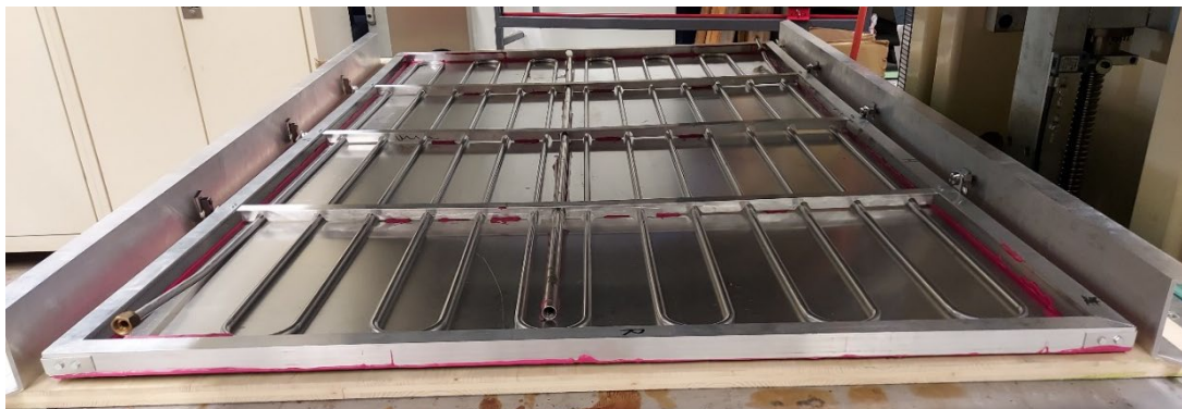
Abbildung 67: Absorber mit Rahmen und den seitlichen Kollektorrahmen. In der Mitte ist das Hüllrohr des Aktuators zu sehen.
