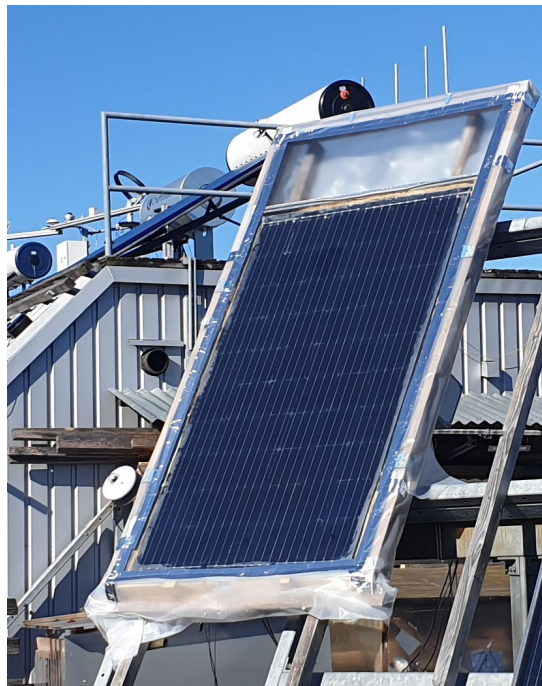
Abbildung 85: Outdoor Exposition des Versuchskollektors mit Silikonabsorber. Der Kollektor befindet sich auf einem Tracker und wird der Sonnen nachgeführt.
