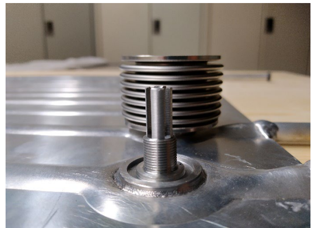
Abbildung 58: Im Vordergrund das aufgeschweisste Anschlussstück, im Hintergrund der montierte Kompensator.
