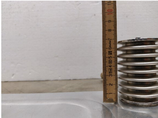
Abbildung 60: Balg nach dem Materialverträglichkeitstest.
