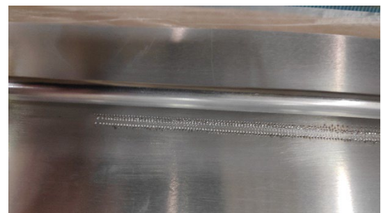
Abbildung 45: Aluminium-Absorberbleche mit aufgeschweisstem Mäander Abbildung 44: Probleme beim Alanod-beschichteten Blech
