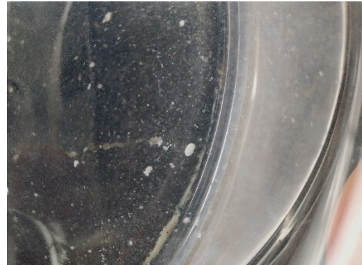
Abbildung 61: Ausfällungen im Fluid des Aktuatorkreises
