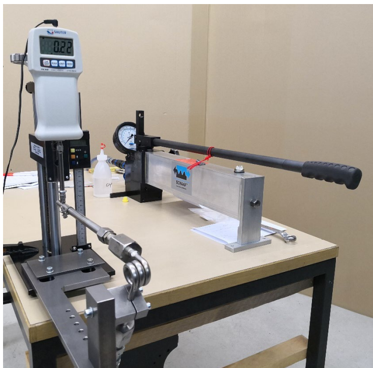
Abbildung 20: Messstand zur Bestimmung der Federeigenschaften. In der Bildmitte ist die Hochdruck-Handhebelpumpe (bis 2'500 bar) zu sehen, links oben die Kraft-Weg-Messeinrichtung und links unten im Vordergrund die Bourdonfeder mit verlängertem Schenkel.
