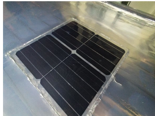
Abbildung 47: 4-Zellen-Versuchsprototyp nach dem Laminieren. Bei den linken zwei Zellen wurden die Drähte wieder aus dem Silikon herausgezogen. Bei den zwei Zellen rechts befinden sich die Drähte noch unter den Zellen.
