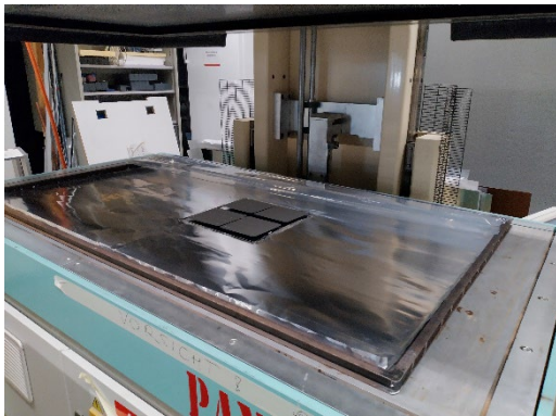
Abbildung 46: 4-Zellen Versuchsprototyp im Laminator. Die Zellen werden durch 0.1 mm Wolfram-Drähte über dem Substrat gehalten.
