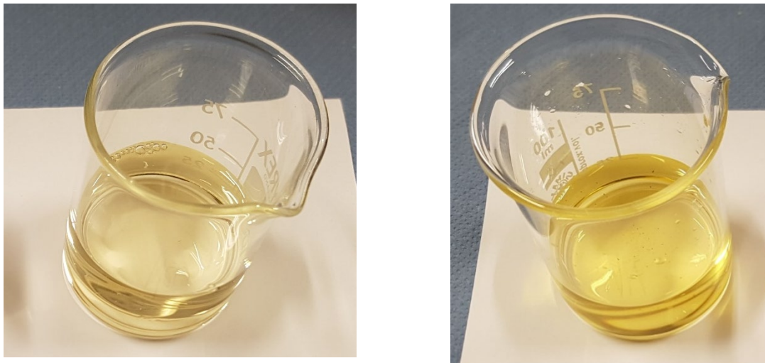
Abbildung 62: (a) Glykol-Wassergemisch vor und (b) nach dem Versuch
