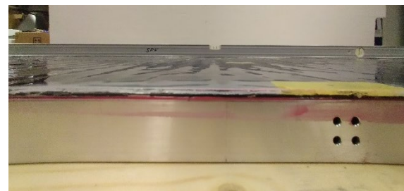
Abbildung 54: Silikonabsorber mit aufgetragener ETFE Schutzfolie. Die Wasserwaage zeigt die Durchbiegung des Absorbers in Längsrichtung
