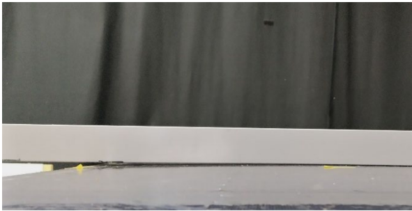
Abbildung 76: Durchbiegung des EVA-Absorbers bei a) Raumtemperatur 23°C und b) in der Klimakammer bei 85°C
