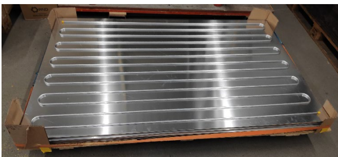
Abbildung 45: Aluminium-Absorberbleche mit aufgeschweisstem Mäander Abbildung 44: Probleme beim Alanod-beschichteten Blech
