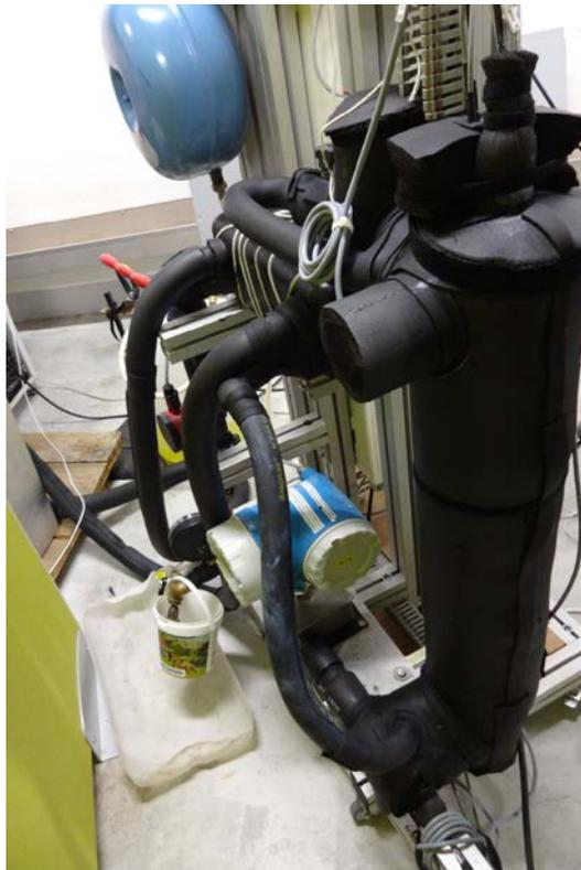
Abbildung 4: Verbesserte Wärmedämmung Versuchsaufbau
