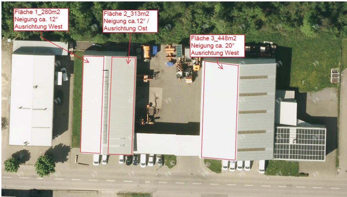
Abbildung 24: Dachflächen und Ausrichtung möglicher Dächer bei der geplanten Zentrale des Wärmeverbundes Aadorf.
