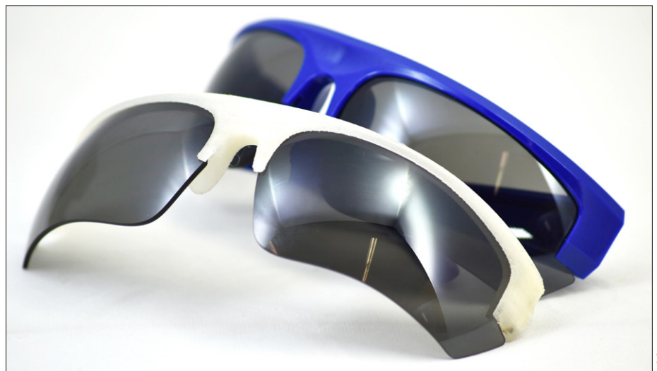
Bild 1: Spritzgegossene Sonnenbrillen (blau) und Prototyp aus Originalmaterial hergestellt im AKF-Verfahren.
