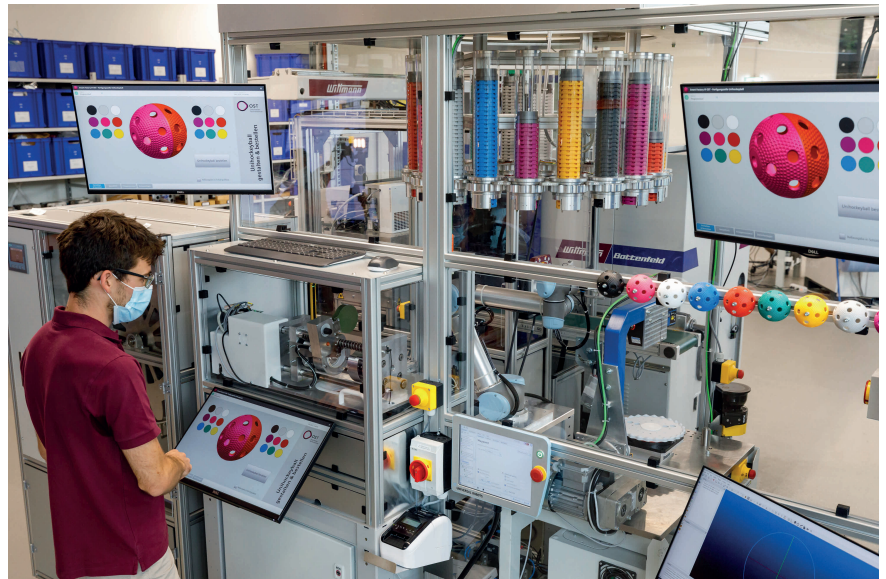
Vollautomatisierte Fertigungszelle zur Produktion eines Unihockeyballs im Technikum des IWK in Rapperswil © Ostschweizer Fachhochschule
