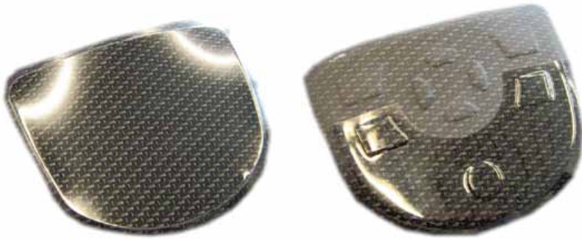
Bild 5: Hinterspritze TPU-Folie (links). PUR-überflutetes Bauteil (rechts)
