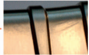
Bild 6. Ein Vergleich des simulierten hinterspritzten Bauteils (links) mit einem realen (rechts) zeigt: In der Fertigung zeichnen sich nicht spürbare Linien an den Oberflächen ab, die die Simulation nicht mehr abbildet
