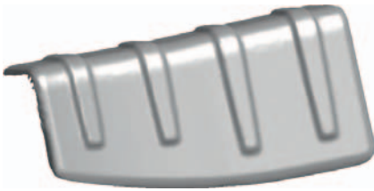
Bild 6. Ein Vergleich des simulierten hinterspritzten Bauteils (links) mit einem realen (rechts) zeigt: In der Fertigung zeichnen sich nicht spürbare Linien an den Oberflächen ab, die die Simulation nicht mehr abbildet
