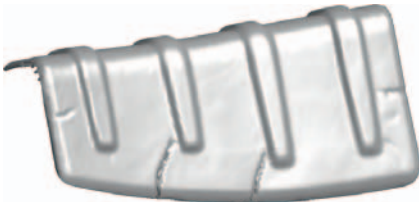
Bild 7. Wird die Druckverteilung im Hinterspritzprozess verändert, bilden sich Falten am Auslauf der Oberflächenstrukturen; hier stimmt die Simulation erneut mit der Praxis überein
