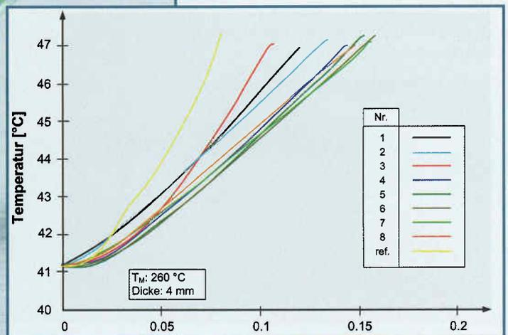
▲ Temperatursensoren überwachen und steuern Spritzgießprozesse. Dabei müssen sie schnell auf Temperaturveränderungen reagieren können. Das IWK untersuchte verschiedene Sensortypen auf ihr Ansprechverhalten, beispielsweise einen Sensorkörper aus Macor – einem mechanisch bearbeitbaren keramischen Werkstoff.
