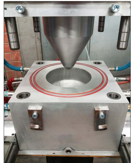
Bild 3: RTM-Werkzeug zur Herstellung des Nose Cones am IWK.
