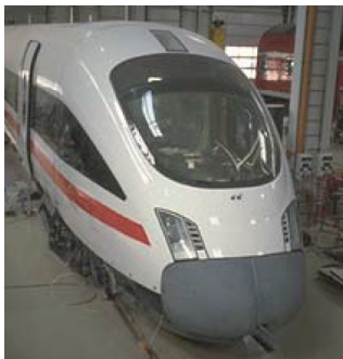
Abb. 1: Bilder von typischen Sandwichbauteilen. Links: Führerstand von einem Hochgeschwindigkeitszug [1]. Mitte: Innenverkleidung eines Flugzeuges [2]. Rechts: Unterelement aus dem Automobilbau [3].
