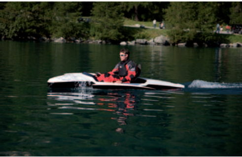
Bild 4. Erste Versuche, um das Fahrverhalten zu testen, zeigten: Bei geringer Geschwindigkeit (< 15 km/h) liegt das Boot ganz im Wasser (links), bei ungefähr 15 km/h hebt es sich teilweise aus dem Wasser (Mitte) und bei Geschwindigkeiten größer 15 km/h ist der Bootsrumf über dem Wasser (rechts); gut zu erkennen ist auch, dass weniger Wasser aufgewirbelt wird – d.h. wenig Verlustleistung tritt auf
