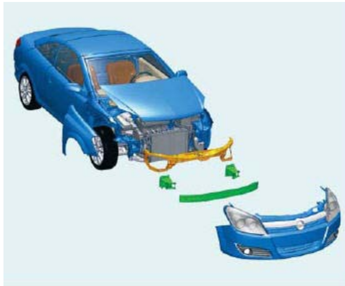
Abbildung 3: Modularer Aufbau einer Vorderwagenstruktur.
