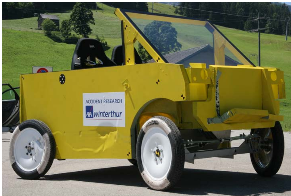
Abbildung 16: Fahrzeugstruktur nach dem Seitencrash mit 40km/h.
