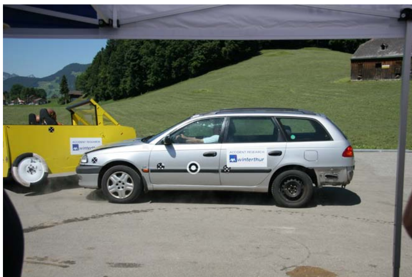
Abbildung 17: Seitliche Kollision mit einem PKW (1'400 kg) mit 40km/h.
