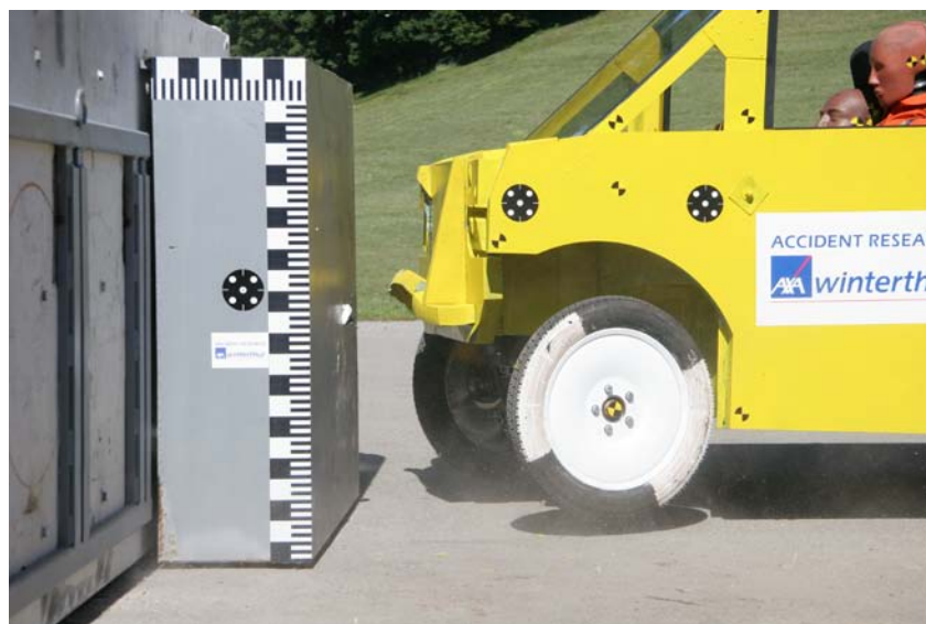
Abbildung 13: Frontalkollision mit 40km/h und 75% Überlappung gegen eine starre Barriere.
