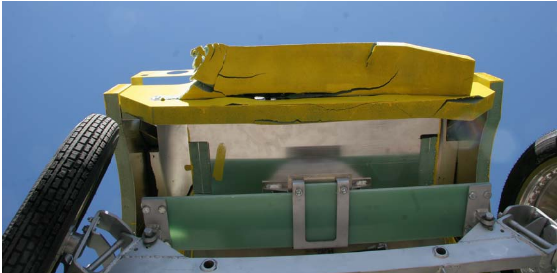
Abbildung 14: Schaumbruch im Strukturschaum vor der Frontplatte.
