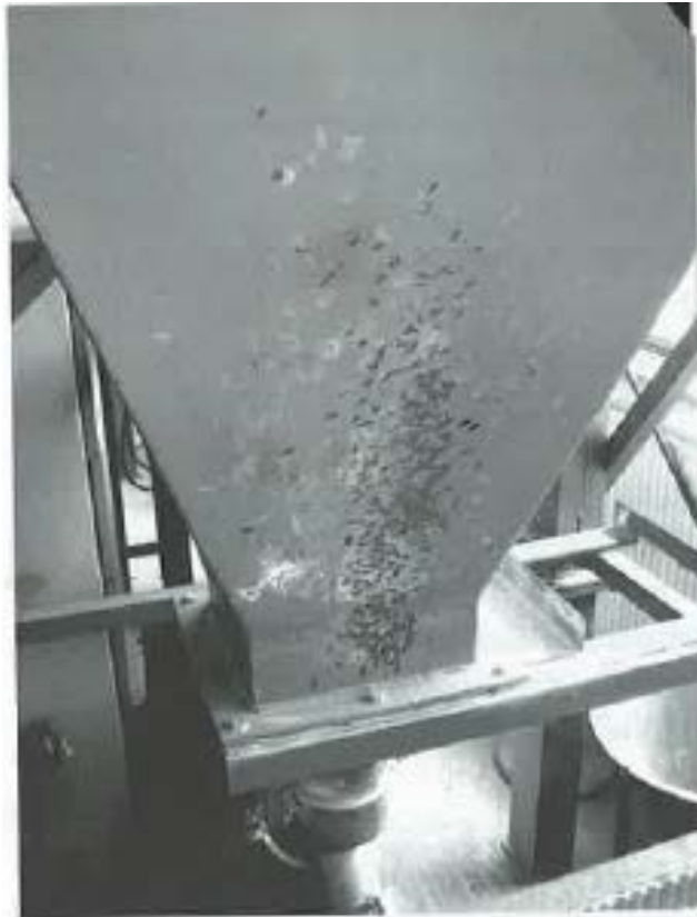
Abb. 1.1: Spuren von Hammerschlägen am Trichter – Zeichen für Fließprobleme
