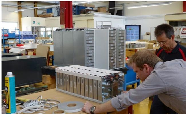
**BILD 2** Montage Batteriestack (total 16 Stacks pro Batterie)
