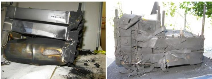
**BILD 9** Temperaturen beim Ausbreitungstest, Zellen nach dem Ausbreitungstest
