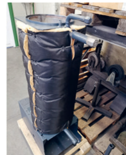
Darstellung Funktionsmuster Gas-Brennwert-Kessel Eigene Darstellung
