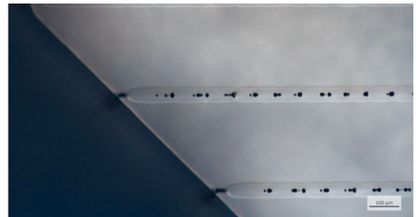
Mikroskopaufnahme einer Mikrochevron-Teststruktur mit uneinheitlicher Verteilung der Bondstärke
