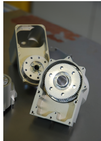
Abbildung 4: Roboterjunkt mit Kabeldurchführung durchs Zentrum des Harmonic-Drives
