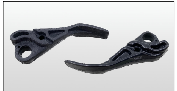
Schalthebel aus SLS-Einsatz mit Kugelstrahlverdichten (Links) und aus SLS-Einsatz mit Epoxidharzbeschichtung (Rechts) Eigene Darstellung
