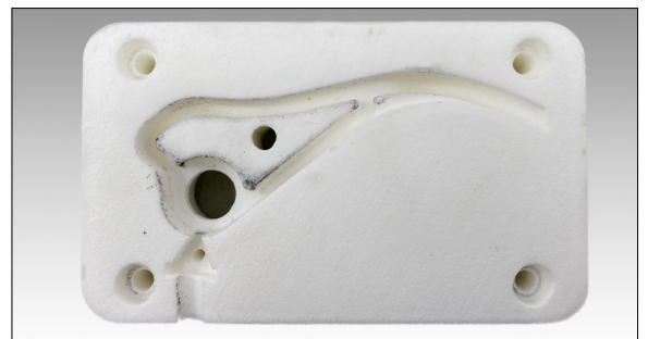
Verschleiss nach der Füllstudie am SLS-Einsatz mit Kugelstrahlverdichten als Post-Processing Eigene Darstellung
