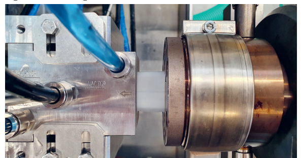
Abb. 3: Einzug des extrudierten Profils in die Kalibrierung
