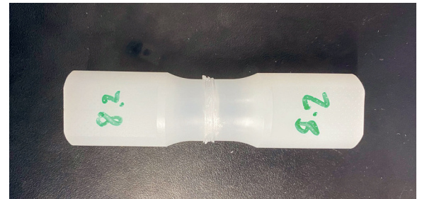
Zugprobe aus Polypropylen, geschweisst auf der CNC-Variante Eigene Darstellung
