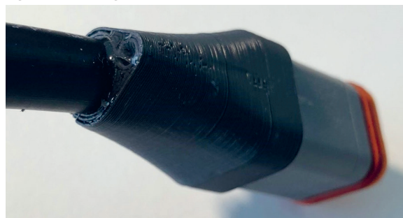
Aktuelle Lösung des Steckers mit Abdeckung und Giessharz Eigene Darstellung
