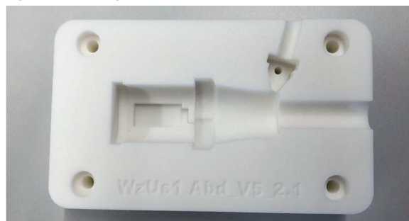
Werkzeugeinsatz aus dem SLS-Verfahren aus PA 12 Eigene Darstellung
