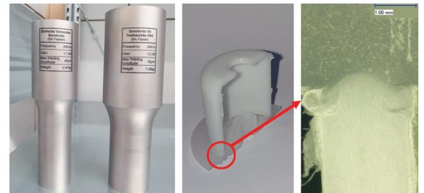
Abbildung 2 (v.l.): Sonotrode, geschweisstes PP-Bauteil, Schliffbild der Schweißnaht.
