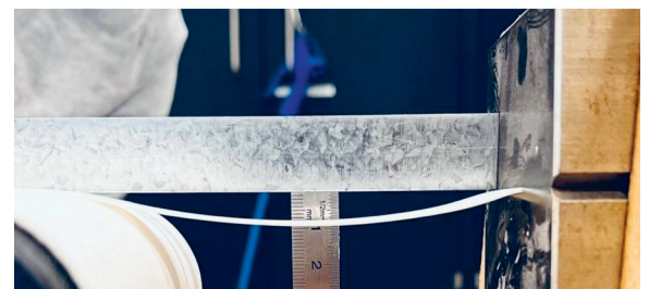
Abb. 2: Messung der Durchbiegung unter Eigengewicht bei Veränderung der Abzugsgeschwindigkeit Eigene Darstellung
