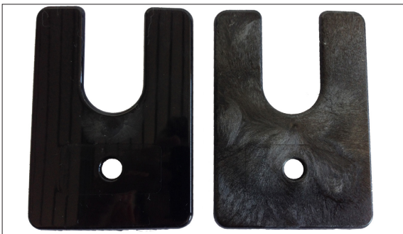
Auswirkung der variothermen Werkzeugtemperaturführung auf die Oberfläche geschäumter Bauteile (links) im Vergleich zur isothermen Variante (rechts)
