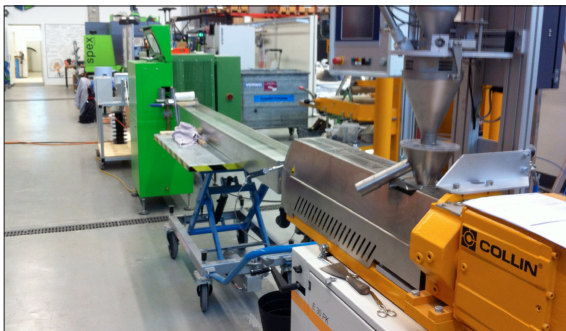
Extrusionsanlage mit provisorischem Wasserbad
