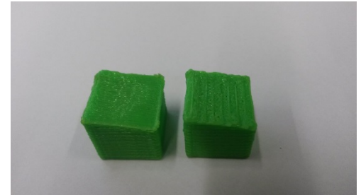
Oberflächenverbesserung: mit Orthogonalaufrag (links), ohne Orthogonalaufrag (rechts)
