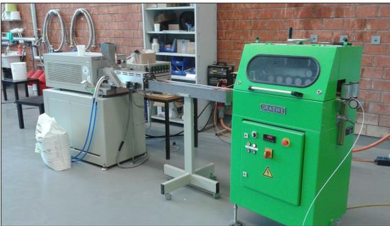
Aufbau der Extrusionsanlage für die Filamentproduktion
