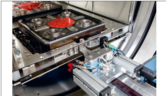
Greifer innerhalb der Reinigungsanlage
