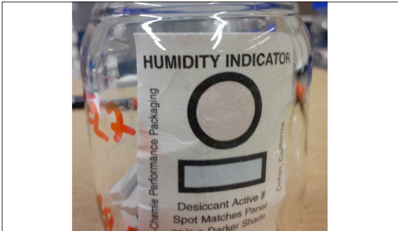
Abb. 1: Indikator-Kurzzeittest zur Bestimmung der Trockenmittelaktivität (inaktiv)
