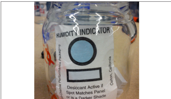
Abb. 2: Indikator-Kurzzeittest zur Bestimmung der Trockenmittelaktivität (aktiv)
