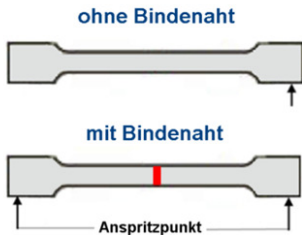
Erläuterung Bindenaht (Zugstab)
