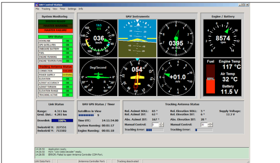
Applikation zur Verarbeitung der von der Flugdrohne empfangenen Daten. Die berechneten Tracking-Winkel werden an den Antennencontroller übermittelt.
