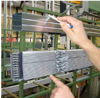
Mass der Schräghangkontrolle
