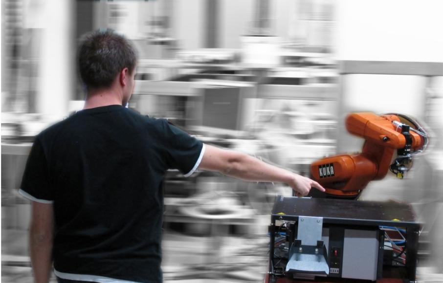
Ein Punkt auf dem Boden wird angedeutet und der Roboter fährt an die entsprechende Position (mit Skalierung von 1:10 verkleinert)
