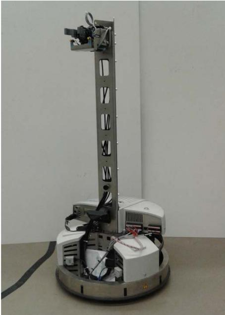
Robotino 3 mit Turm und Greif-Schwenk-Modul
