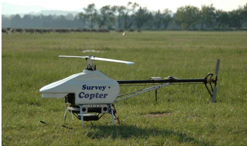
Der Helikopter Copter City, der für Flugversuche zur Verfügung stand. Der Rotordurchmesser beträgt 1.8 m.
