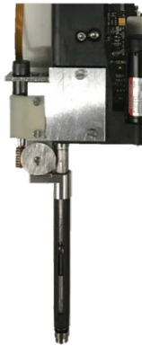
Funktionsmuster Tipkopplungsmechanismus (Baubreite 9 mm)
