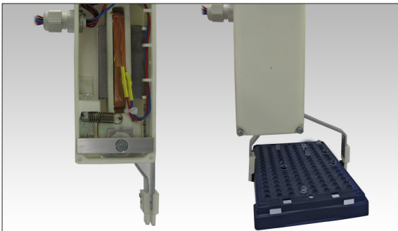
Das Greifermodul ohne Deckel (links) und beim Transportieren einer Plate
