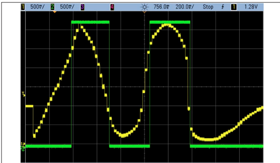
Von der Testbench generiertes Signal zur Prüfung des Schmitt-Triggers
