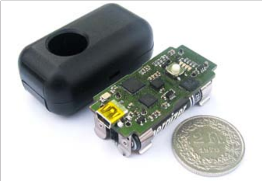
Sensormodul zur Erfassung der Geschwindigkeitsdaten
