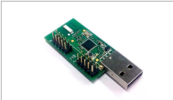
Funkmodul am Host: «CC1111» USB Dongle von Texas Instruments
