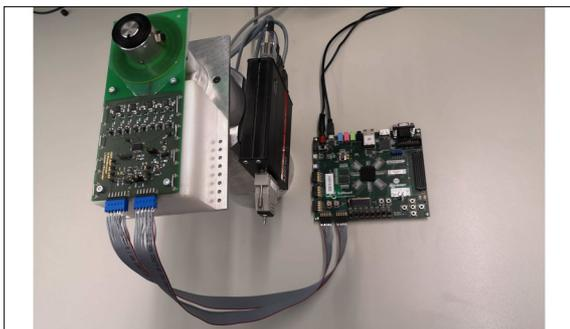
Bild 3: Aufbau Zed-Board, PCB, Motor
