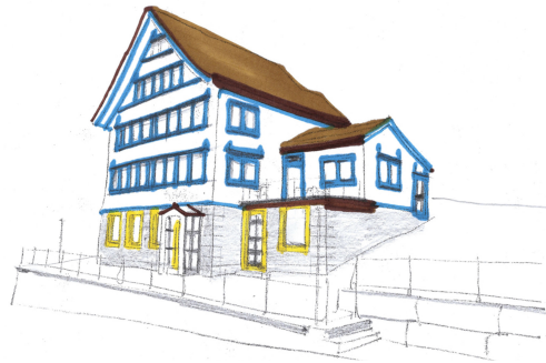
Die formalen Elemente wie Dach, Fenster und Abwürfe eines Hauses, übertragen auf einen Anbau, sind wichtige Kriterien für eine gute Ein-/Anpassung.
