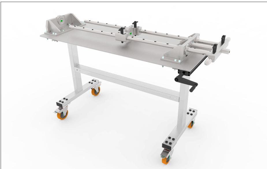
Endversion der Schneckenabzugsvorrichtung
