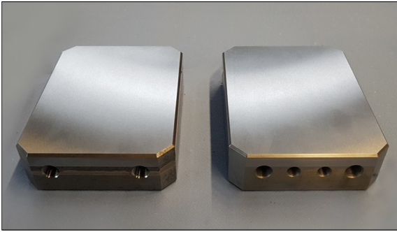
Bild 1: Spritzgiesswerkzeugeinsätze mit runden und eckigen Kühlkanälen Eigene Darstellung
