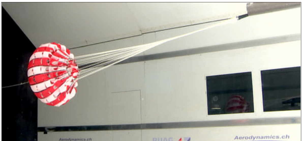
Abbildung 1: Gerefftes Fallschirm-System im Windkanal Eigene Darstellung
