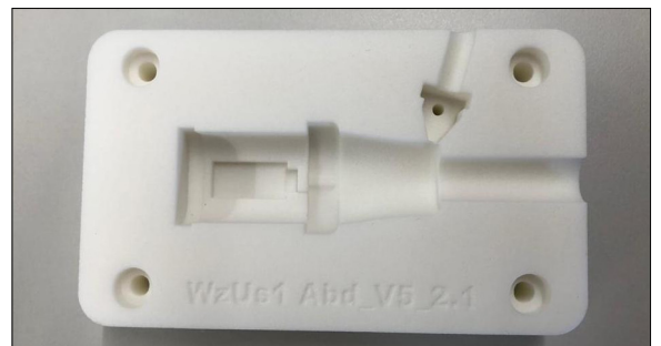
Werkzeugeinsatz aus dem SLS-Verfahren aus PA 12 Eigene Darstellung
