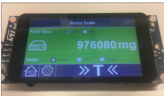
Demonstrator auf Zielplattform (STM32F469I-DISCO) Eigene Darstellung
