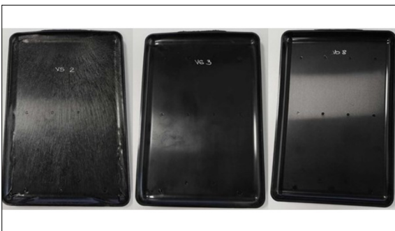
Links: geschäumte Platte mit Kernrückzug, Mitte: geschäumte Platte mit Gasgedrückt, Rechts: kompakte Platte. Eigene Darstellung
