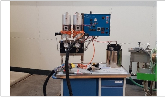
Eingesetzte Niederdruckanlage für die Überflutung
