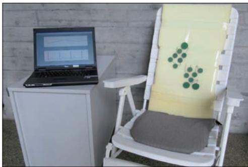
Stuhl mit 14 kapazitiven EKG-Elektroden
